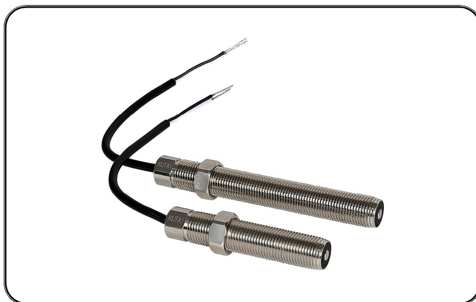
用於監控原動力的轉速。當一鐵磁性物體(常為發電機起動齒輪)經過時 MPU 的末端會產生一磁場，使 MPU 內部感應一電壓信號而這個電壓的頻率做為輸入到速度控制的信號，能準確地測量出原動機的速度。
