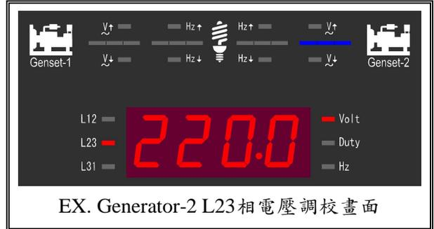
步驟4：使用準確的三用電表讀取欲校正的相位電壓值。
